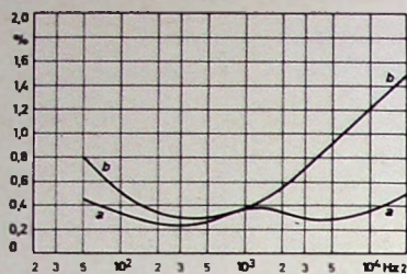
Bild 8. Klirrfaktor des Verstärkers: Frequenzgang linear (a), Höhen und Tiefen angehoben (b)
